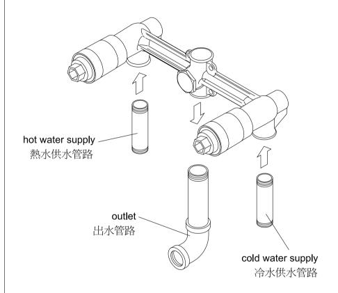
\* Install hot and cold water supply pipes and outlet. 依圖示,安裝冷熱供水管路,與出水管路。
